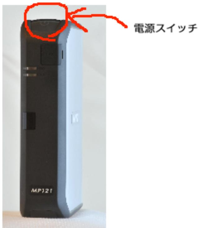
接続が完了したら、リモコンの電源ボタンか、本体の前面の電源スイッチを入れてください。
